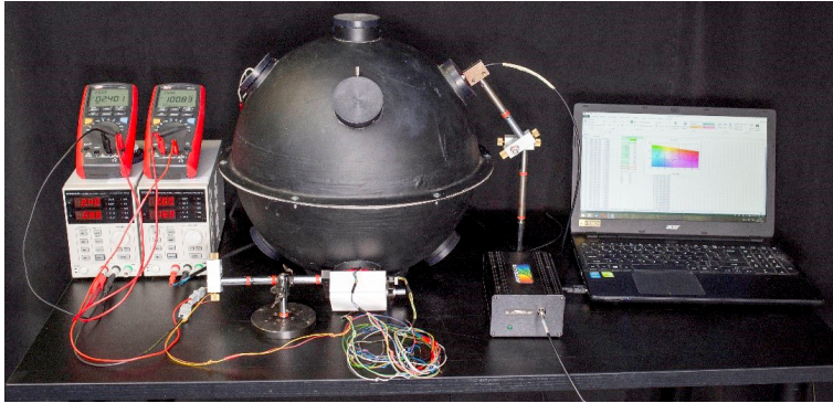
RYS. 2.9. Stanowisko pomiarowe do wyznaczania charakterystyk sygnałów wyjściowych scalonych czujników barwy
