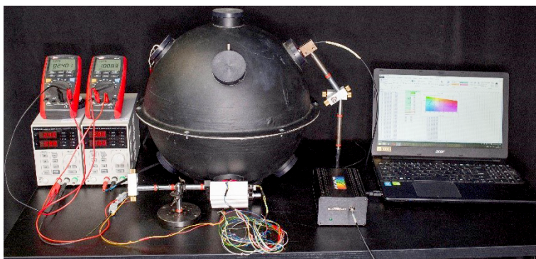
RYS. 2.20. Stanowisko pomiarowe do testowania scalonych czujników barwy
