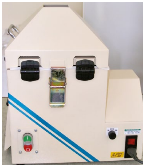
RYS. 4.6. Tester do badania wytrzymałości kinetycznej granulatu NEW HOLMEN PORTABLE NHP100: a) schemat stanowiska, b) widok stanowiska
