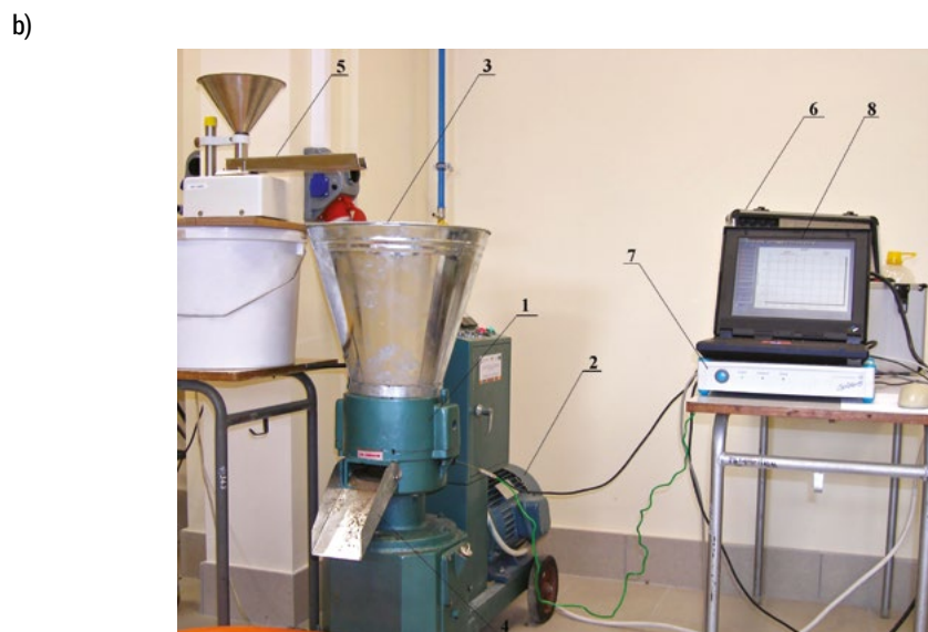
RYS. 4.5. Stanowisko SS-4: a) schemat stanowiska: 1 – układ roboczy granulatora ze stałą matrycą płaską, 2 – silnik elektryczny napędzający granulator (Y132M, 7,5 kW, 1440 obr./min), 3 – zasyp surowca, 4 – wysyp granulatu, 5 – dozownik wibracyjny (FRITSCH LABORETTE 24), 6 – uniwersalny miernik do pomiaru zapotrzebowania na moc (METROL KWS 1083, max. 20 kW), 7 – rejestrator Spider 8, 8 – komputer PC, b) widok stanowiska
