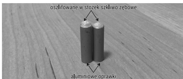
RYSUNEK 5.2. Oszlifowane w stożek szklivo umieszczone w aluminiowych oprawkach
