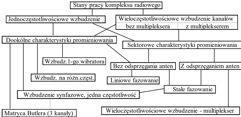
Rys. 7.115. Klasyfikacja stanów pracy wielofunkcyjnego nadawczego układu antenowego
