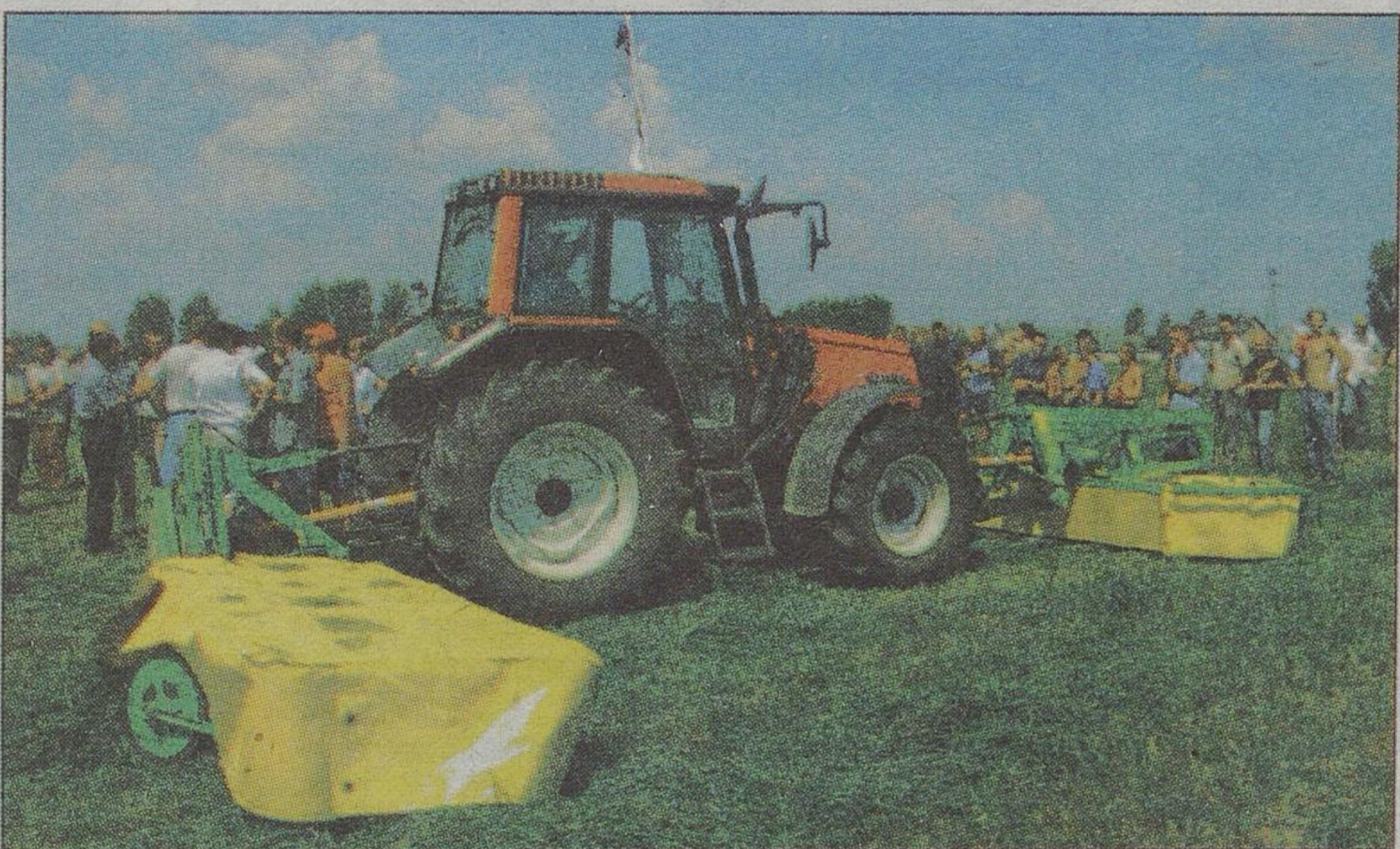
Kosiarki dyskowe tylne i czołowe polecane są dla gospodarstw kilkudziesięciohektarowych i większych, ze względu na ekonomię. Mają one o 20 proc. mniejsze zapotrzebowanie na moc. Prezentowane na pokazie maszyny mają większe szerokości koszenia.
