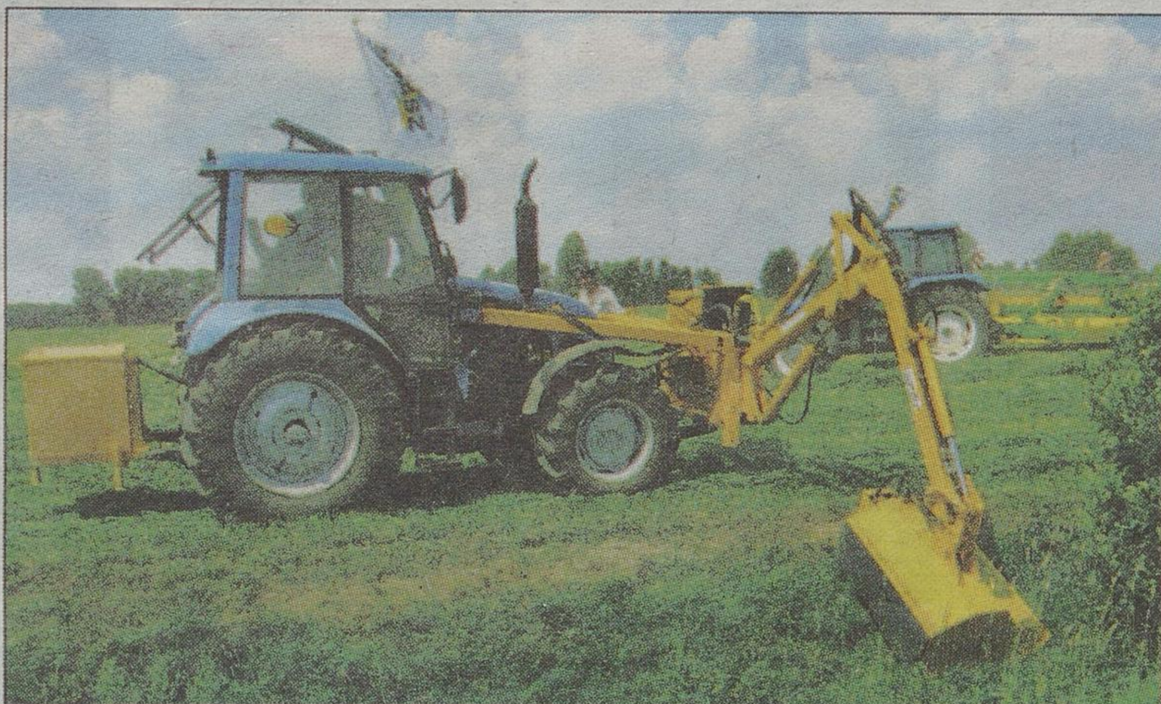
Kosiarka czołowa do rowów i poboczy współpracująca z ciągnikiem Pronaru wzbudzała wielkie emocje wśród oglądających. Słowa uznania wywołało szczególnie ścinanie niewielkich przydrożnych krzewów.
