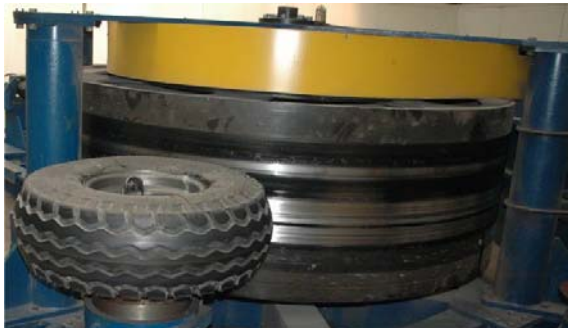
Rys. 1. Maszyna bieżni z badanym kołem zamocowanym w pozycji horyzontalnej
