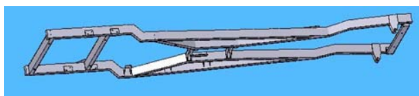
Rys. 5. Piąta postać drgań własnych ramy
