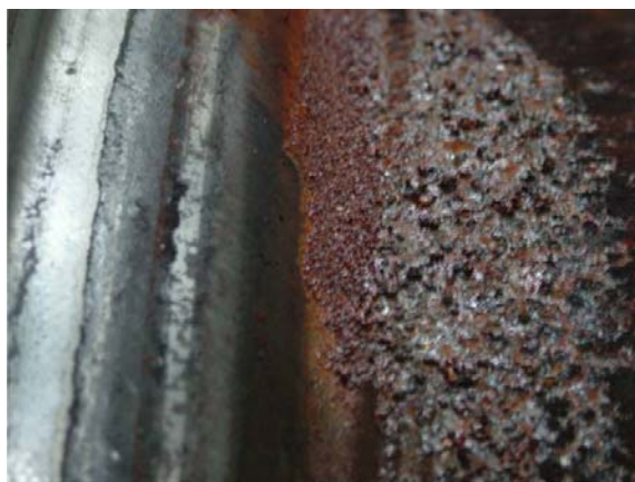
Rys. 4. Ogniska korozyjne w przetłoczeniu obręczy. Na podstawie cech charakterystycznych zakwalifikowano ją jako korozję tlenkową
