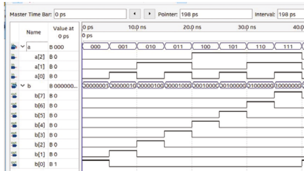
RYS. 5.52. Wyniki symulacji dekodera 3:8 z wykorzystaniem instrukcji assign
