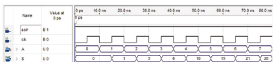
RYS. 8.41. Wyniki symulacji sumatora akumulującego
