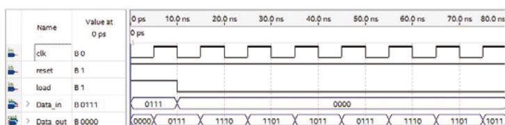
RYS. 6.48. Wyniki symulacji modułu barrel_shift_register
