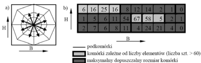
Rys. 6. Nowe podejścia do projektowania typoszeręgów: a) kierunki rozkładu komórek w typoszeręgu opartym na rozkładzie statystycznym, w którym wierzchołek typoszeręgu pokrywa się z maksymalną liczbą elementów; b) przykładowy typoszeręg mieszany
