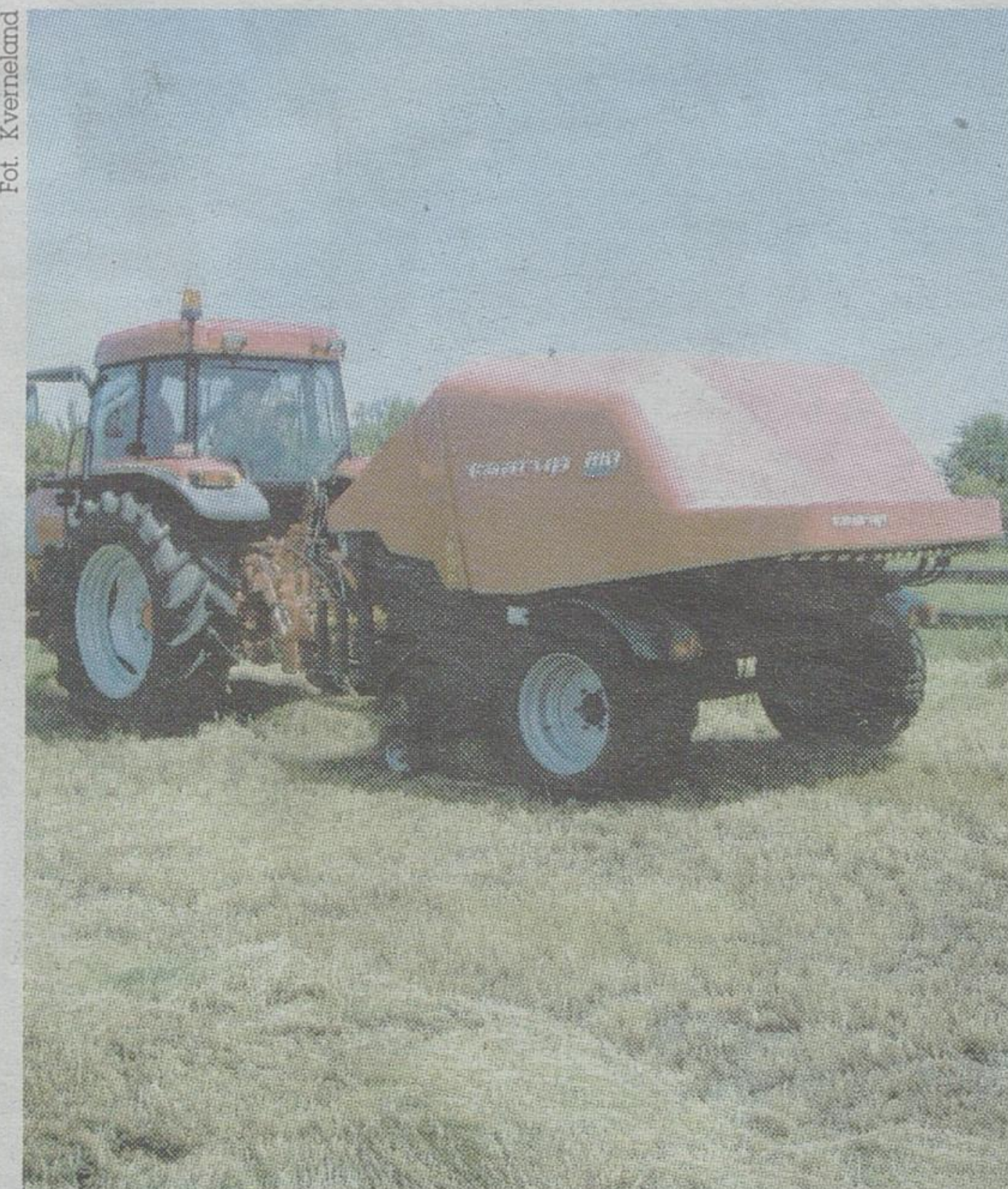
Prasowijarka Taarup BIO (nowość na rynku krajowym) owija bele już w komorze prasowania
