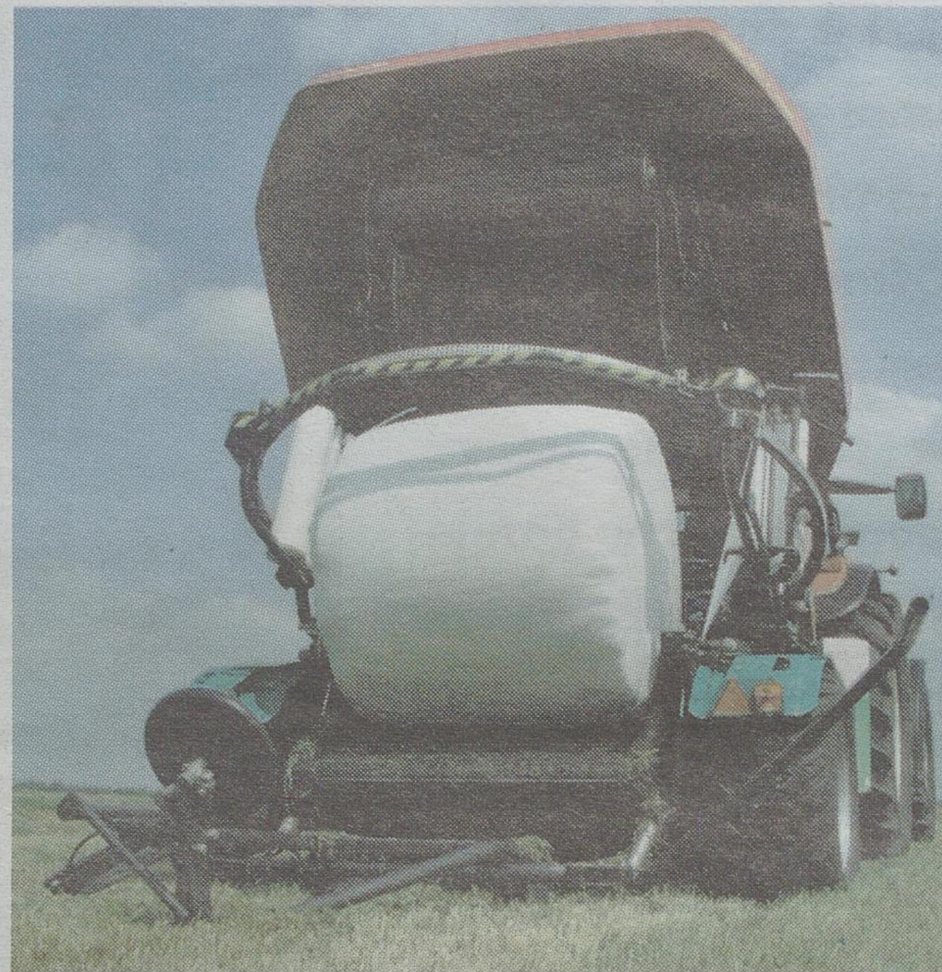
Prasowijarka Taarup BIO (nowość na rynku krajowym) owija bele już w komorze prasowania
