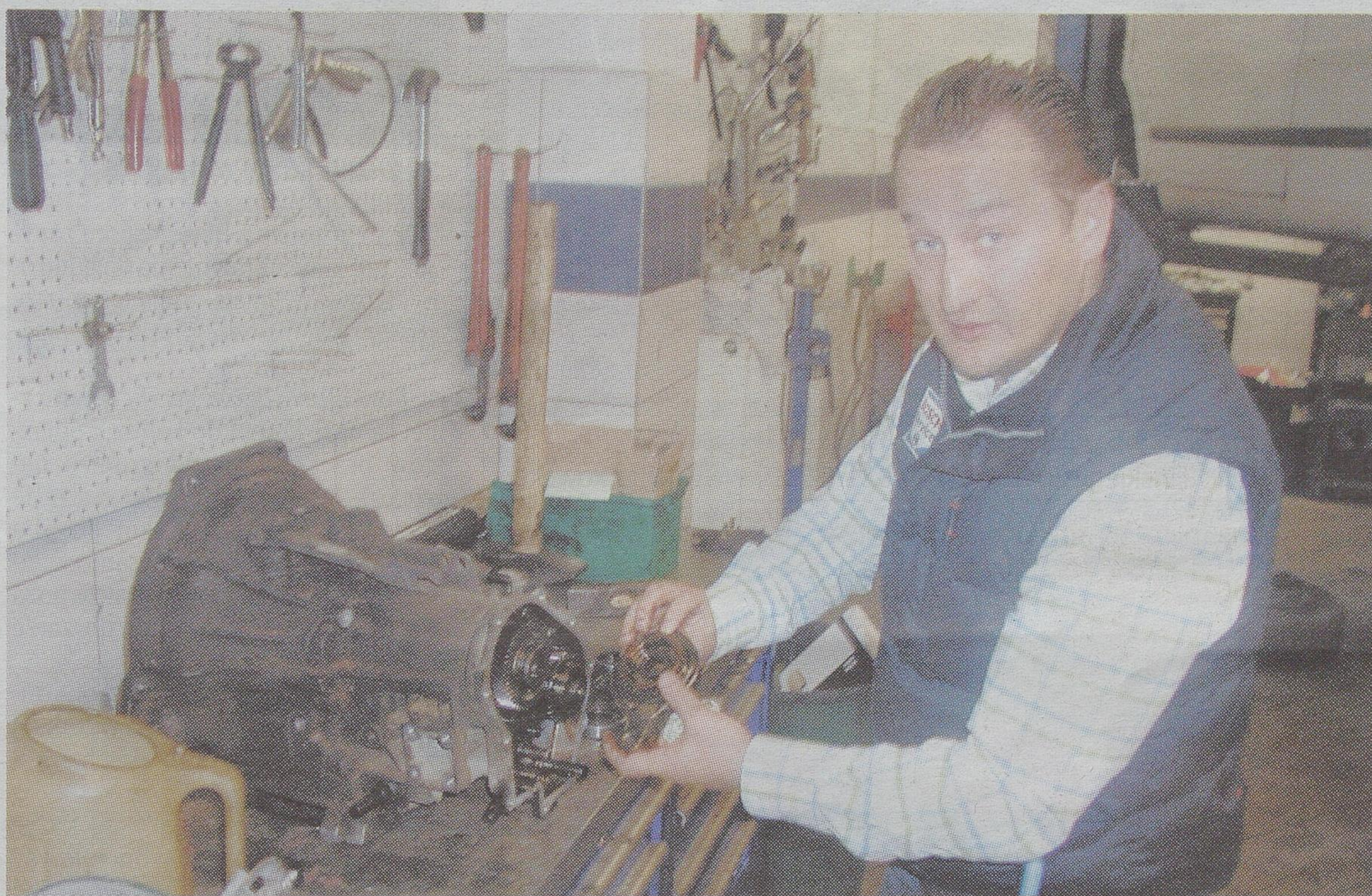
Brak oleju często prowadzi do uszkodzenia łożysk, które nie pracują wtedy w optymalnych warunkach – mówi Paweł Kukielka, szef serwisu Rycar Bosch Service
