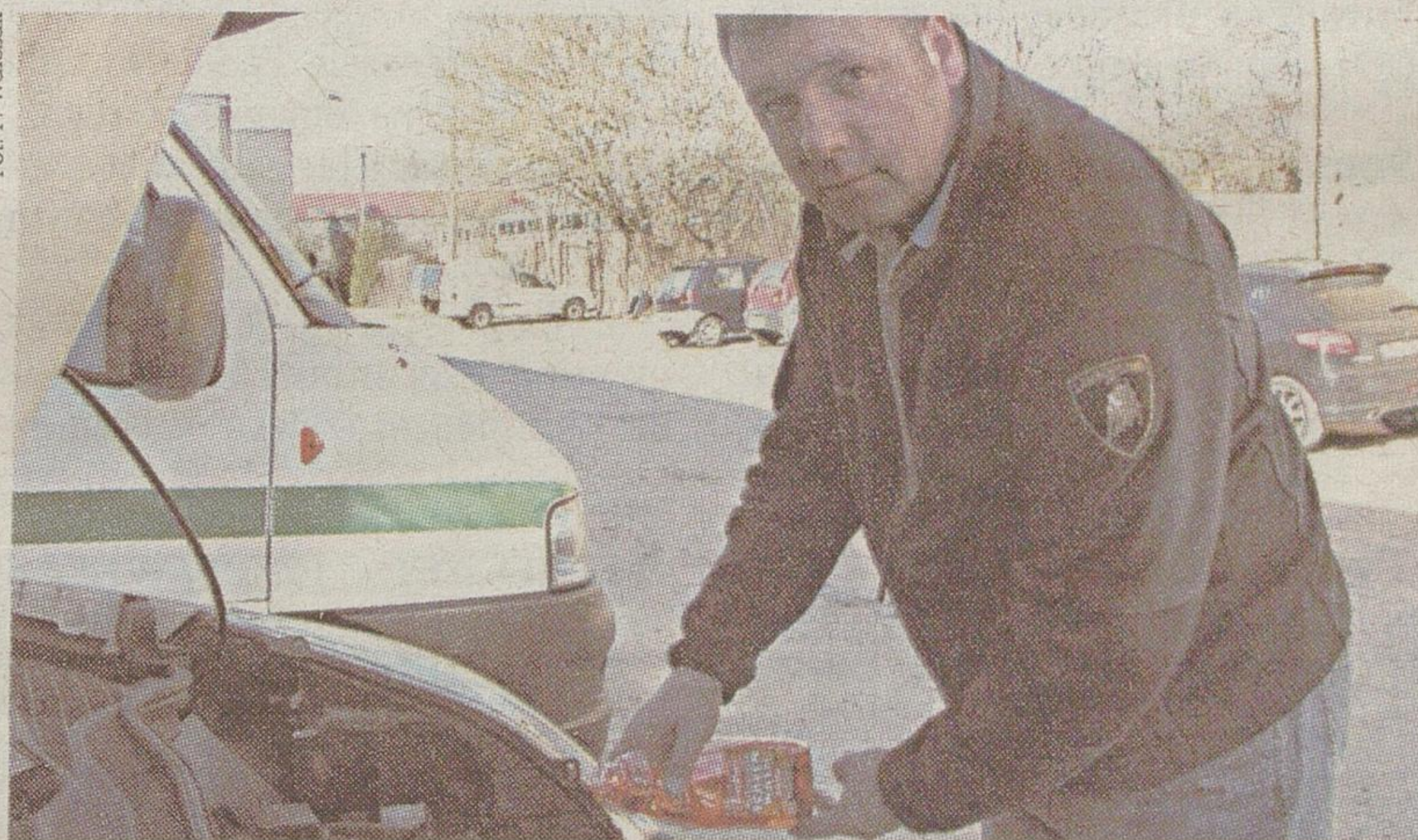
W żadnym wypadku nie uzupełniajmy braków wodą – ostrzega Rafał Witkowski. – Przez nią w przewodach osadzi się kamień.
