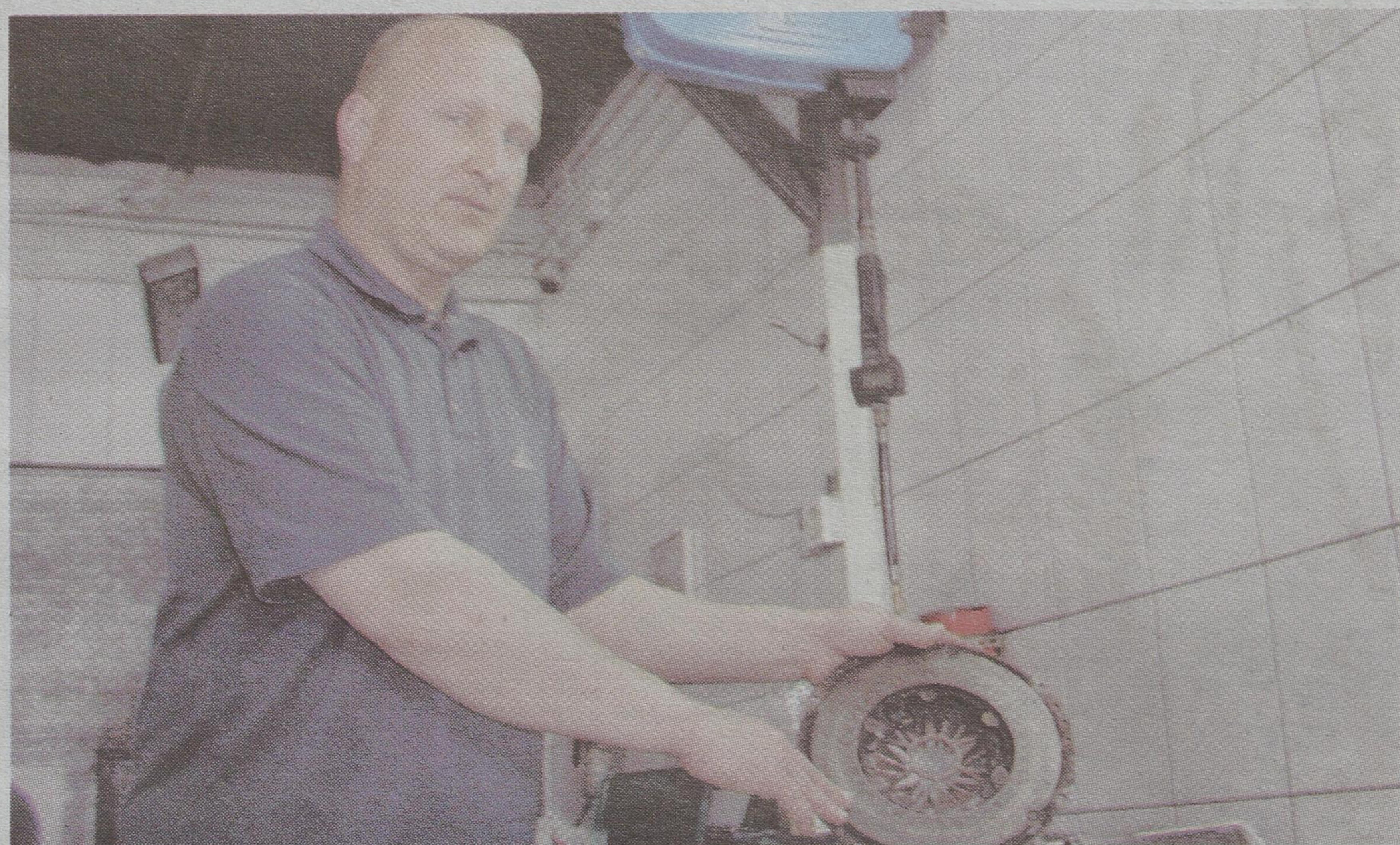
Wysokie obroty silnika, a przy tym tylko częściowa praca sprzęgła, spowodować mogą duży poślizg na tarczy i w efekcie jej spalanie – mówi Jan Wnorowski, kierownik serwisu
