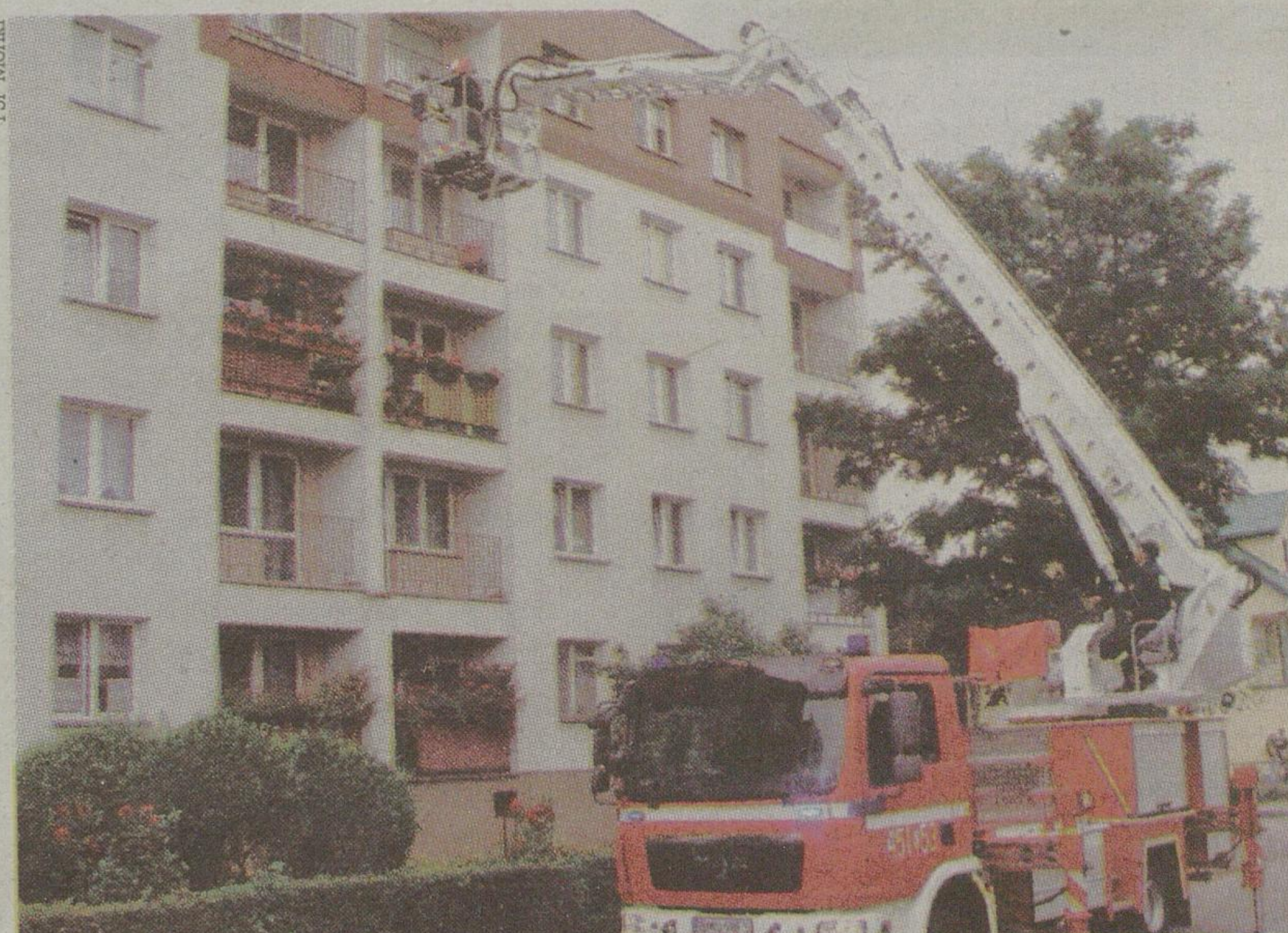
Nowy podnośnik ma zasięg 25 metrów. Strażacy testowali auto m.in. przy blokach na ul. Wyzwolenia.
