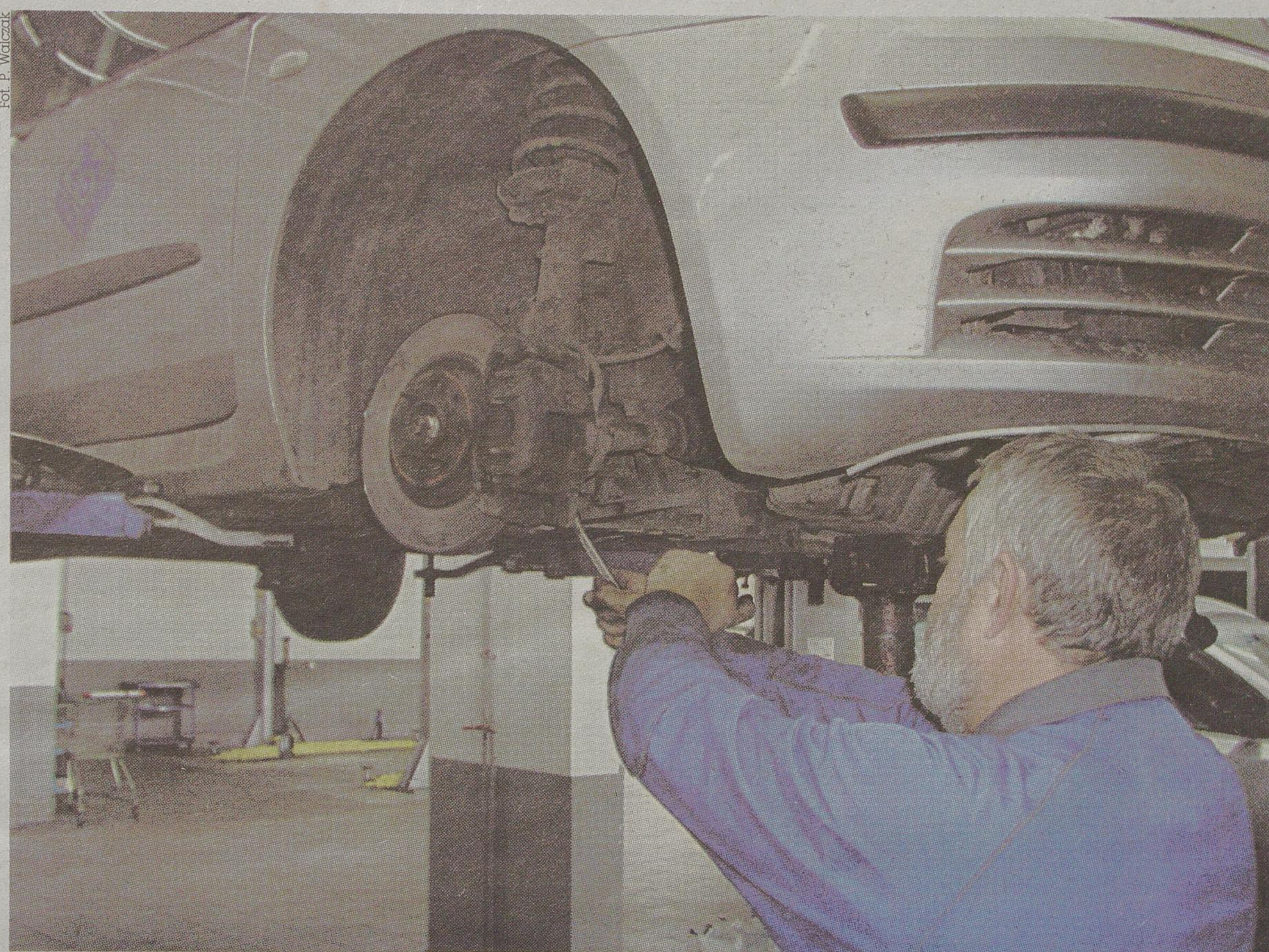
Klocki hamulcowe to jedne z najważniejszych elementów układu hamulcowego. Ich stan powinno się sprawdzać podczas każdego przeglądu.
