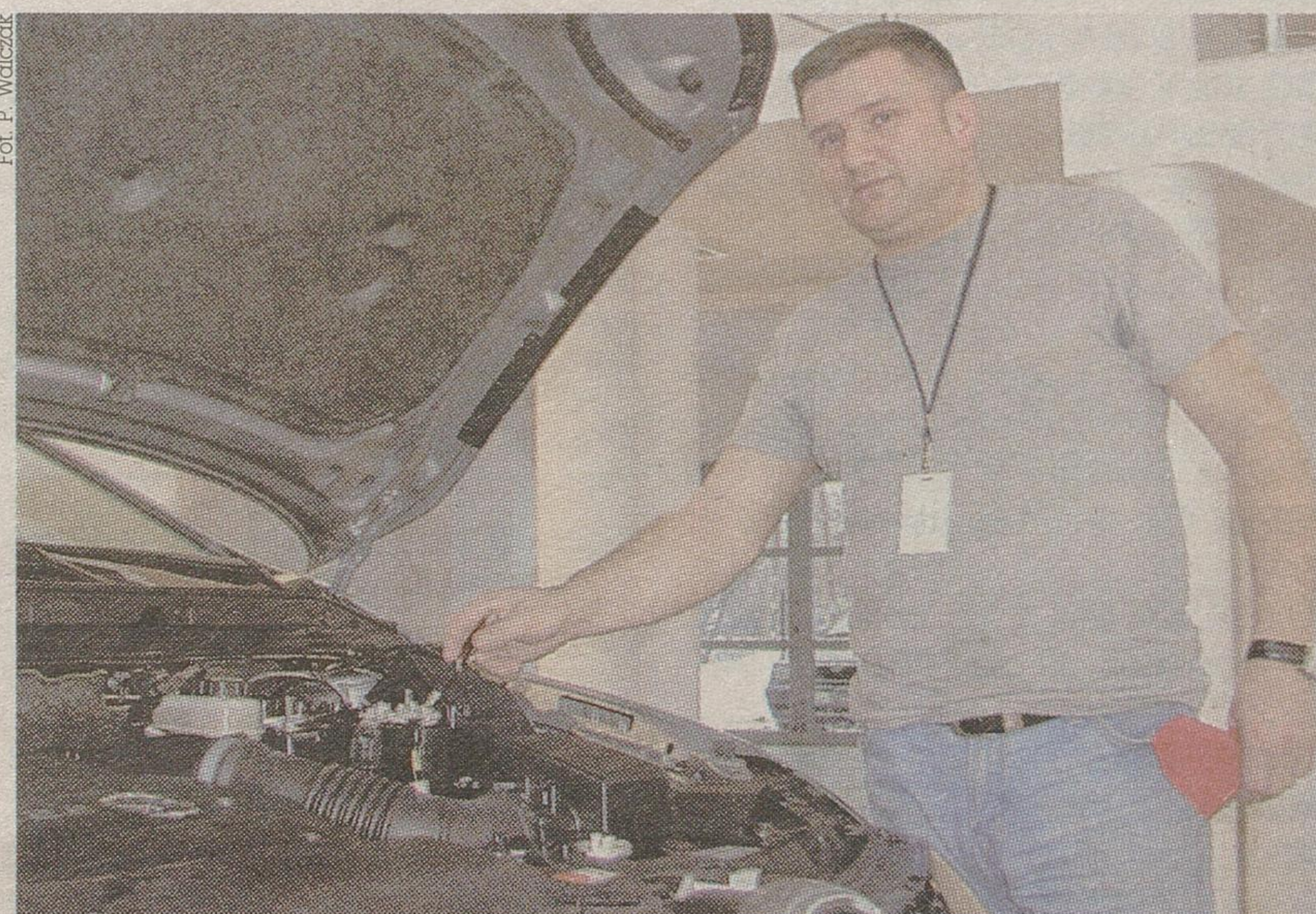
Warto sprawdzać kłemy akumulatora – radzi Jacek Bagiński, kierownik serwisu. – Jeśli są zaśniedziałe, trzeba je wyczyścić.
