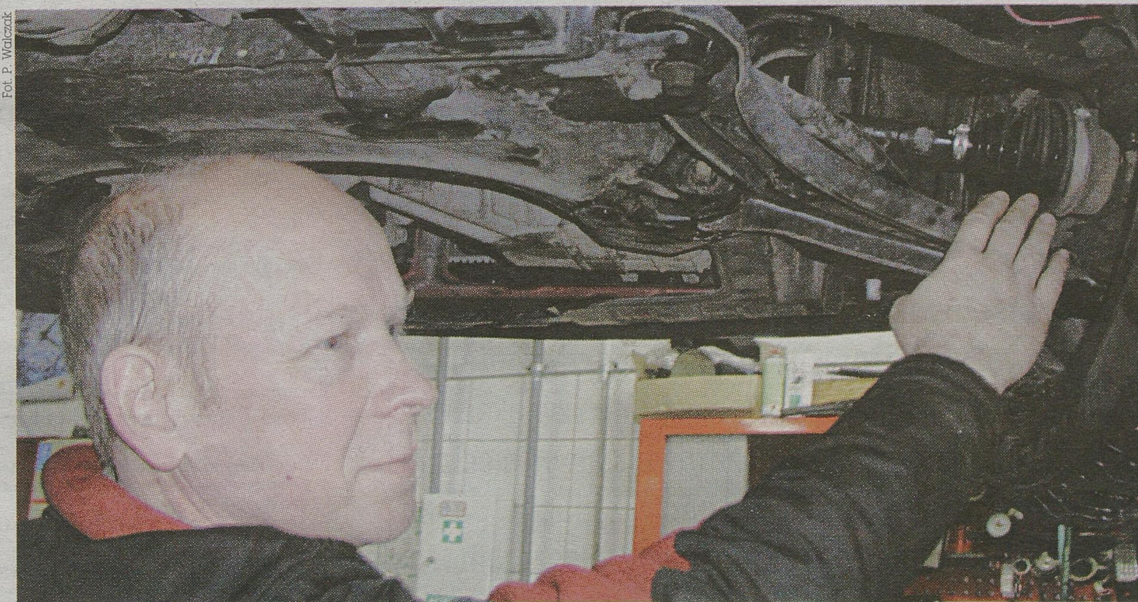
Po zimie sprawdzimy, czy osłony przegubów napędowych nie są uszkodzone i czy nie wydostaje się z nich smar – radzi Andrzej Długosz, doradca serwisowy
