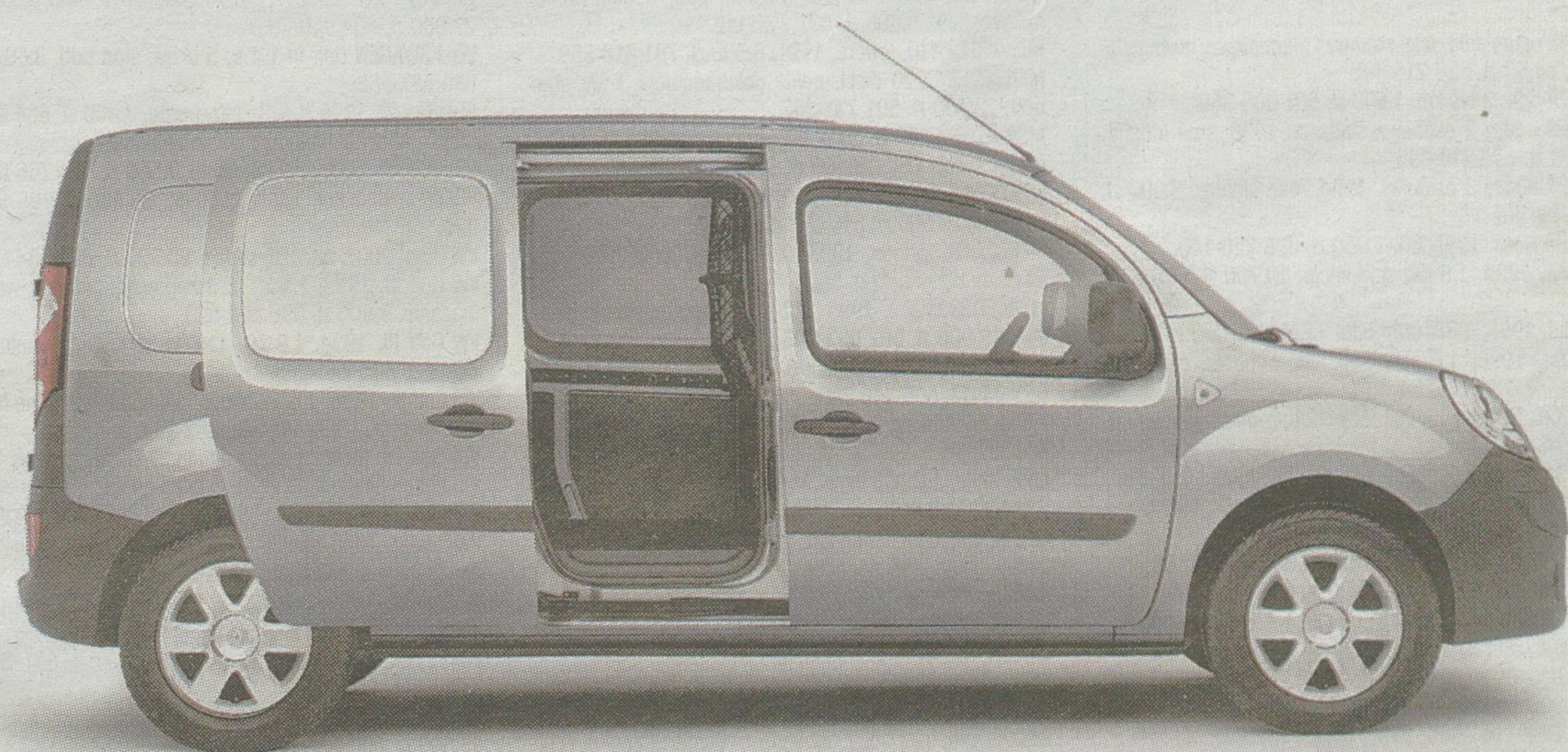
Renault kangoo express maxi wyposażone jest w przesuwne drzwi boczne z prawej strony
