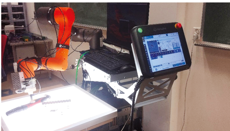
FOT. 3. Robot umieszczający chwytak bezpośrednio nad środkiem jednego z wykrytych obiektów ŹRÓDŁO: oprac. własne.
