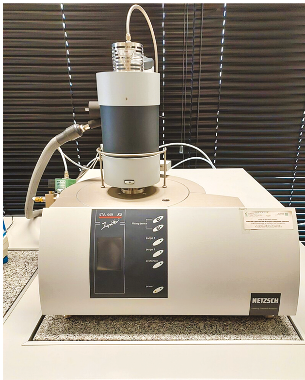
FOT. 3. Stanowisko do badań termomechanicznych DSC/TG
