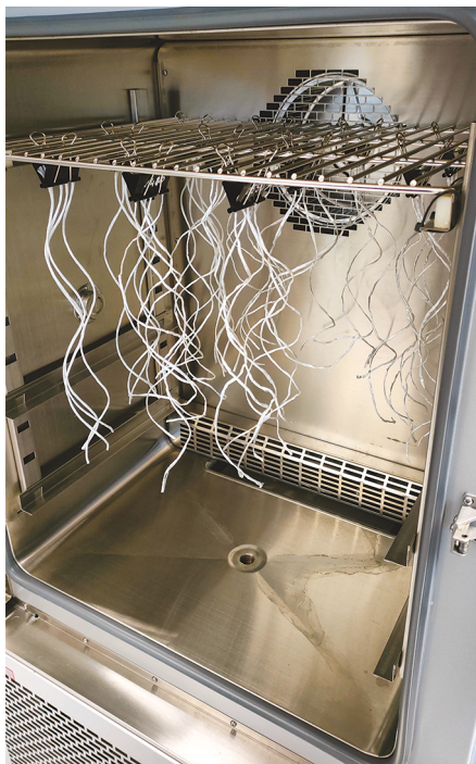
FOT. 4. Komora starzeniowa z umieszczonymi w środku próbkami
