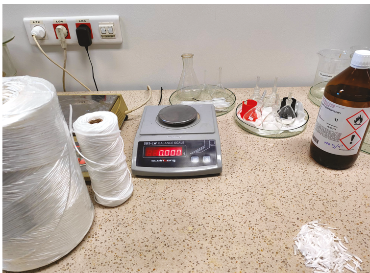
FOT. 5. Stanowisko do badań gęstości normalnej metodą piknometryczną
