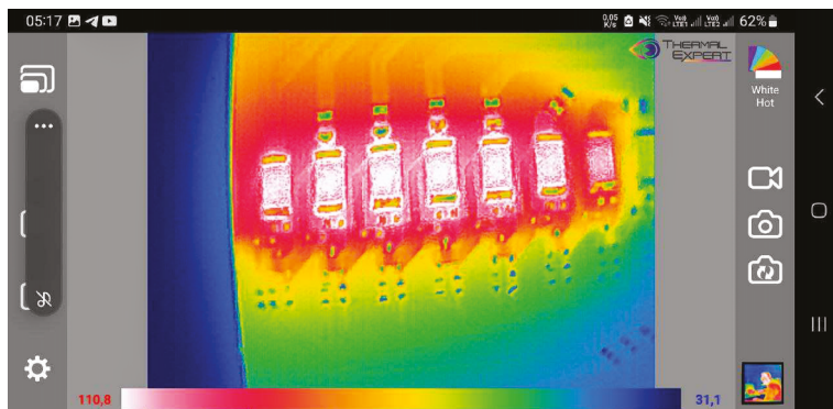
FOT. 9. Rozkład temperatur na układach podrzędnych w trakcie balansowania segmentu typu II
