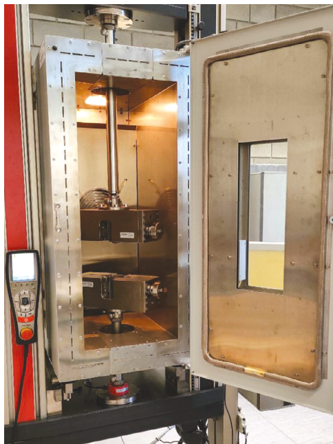
FOT. 1. Stanowisko do badań mechanicznych bez zamontowanej komory temperaturowej oraz z komorą temperaturową
