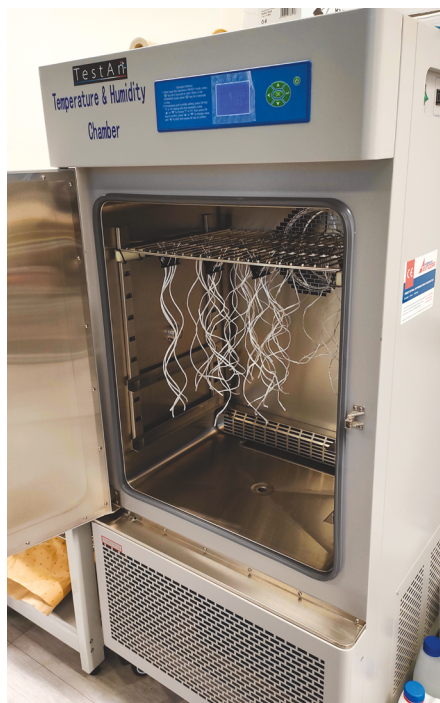
FOT. 4. Komora starzeniowa z umieszczonymi w środku próbkami
