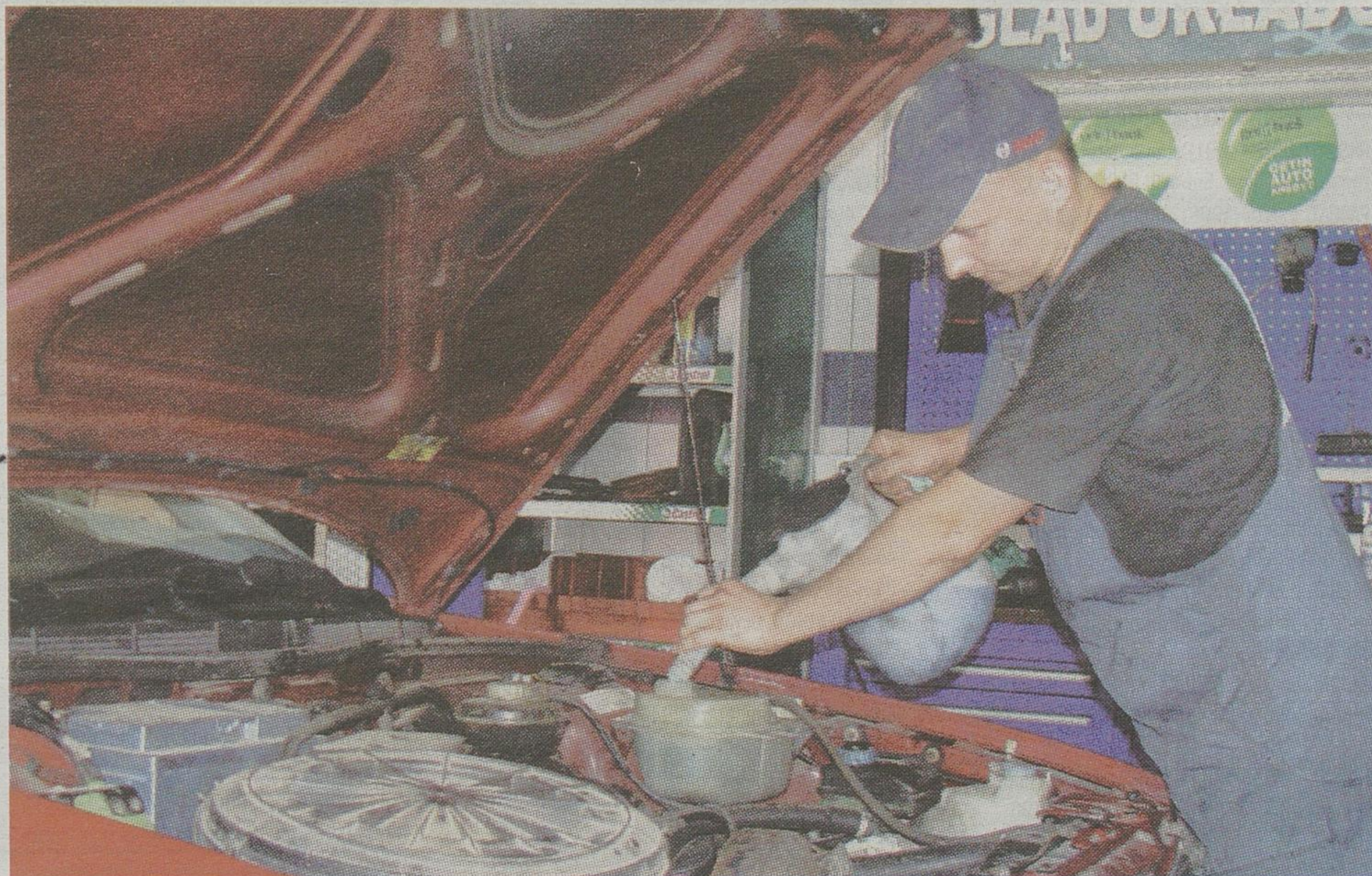
Należy stosować taki olej, jaki zaleca producent silnika. Raz na dwa tygodnie dobrze jest sprawdzić jego poziom.
